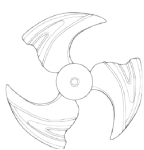
Лопasti с высоким статическим давлением
