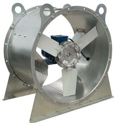
Вентиляторы осевые серии ВО предназначены для перемещения невзрывоопасных газовых сред с температурой от -40 до +40°C, содержащих твердые примеси не более 100 мг/м<sup>3</sup>, не содержащих липких веществ и волокнистых материалов, в условиях умеренного климата 2-й категории размещения по ГОСТ 15150-90.
