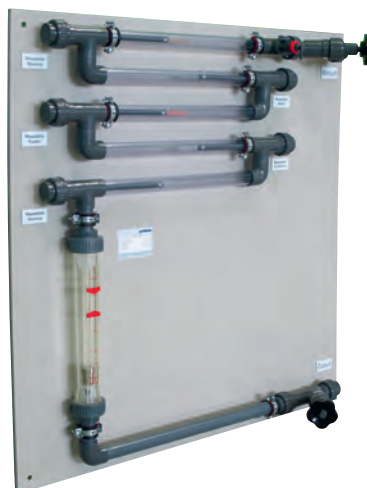
Участок измерения коррозии
